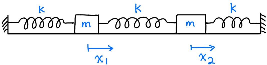
$$\begin{bmatrix} x_1'' \\ x_2'' \end{bmatrix} = -\frac{k}{m} \begin{bmatrix} 2 & -1 \\ -1 & 2 \end{bmatrix} \begin{bmatrix} x_1 \\ x_2 \end{bmatrix}$$
